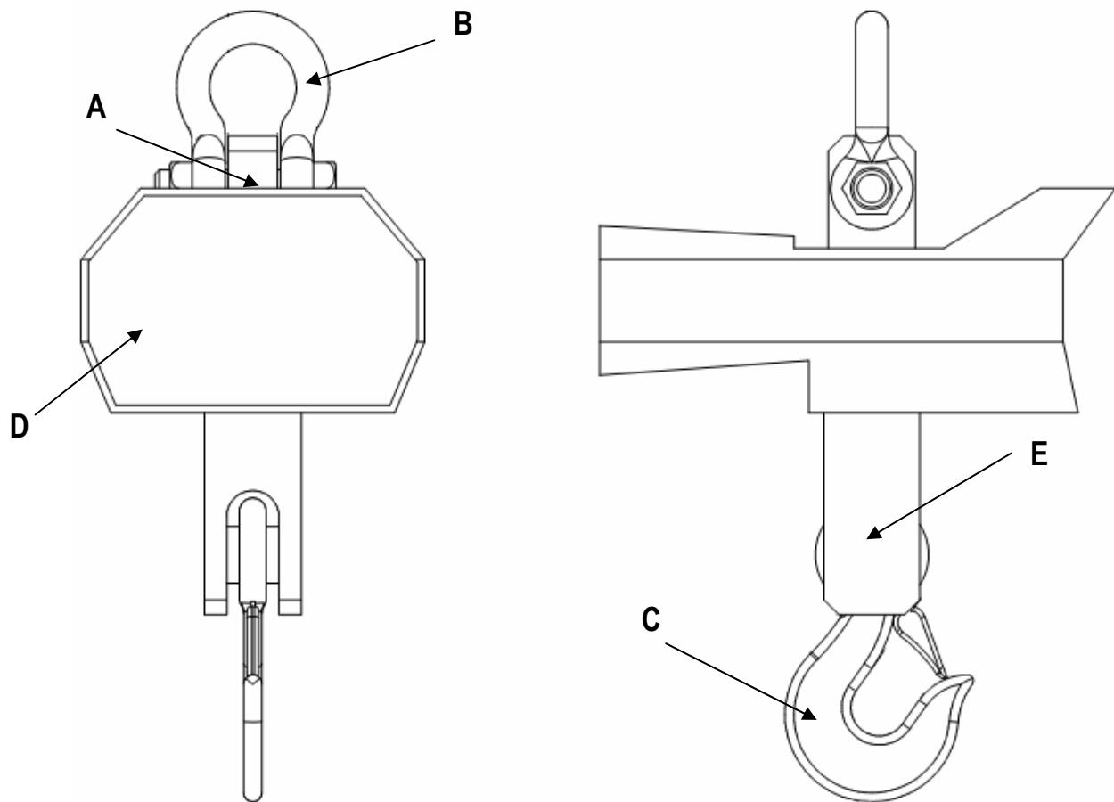
A: corps où se trouve le capteur de charge à traction;
